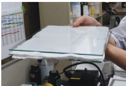
圖 10：木簡冷凍乾燥時夾於玻璃板中固定 (2016.09 於日本奈文研)
