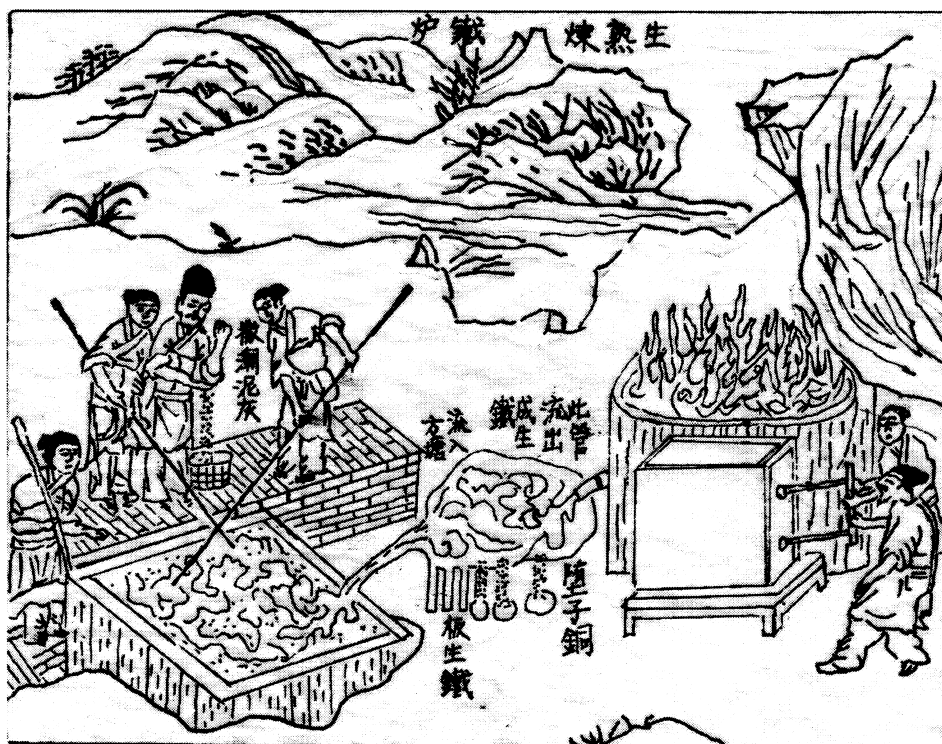
圖一：《天工開物》 10 中的煉鐵與炒鐵
