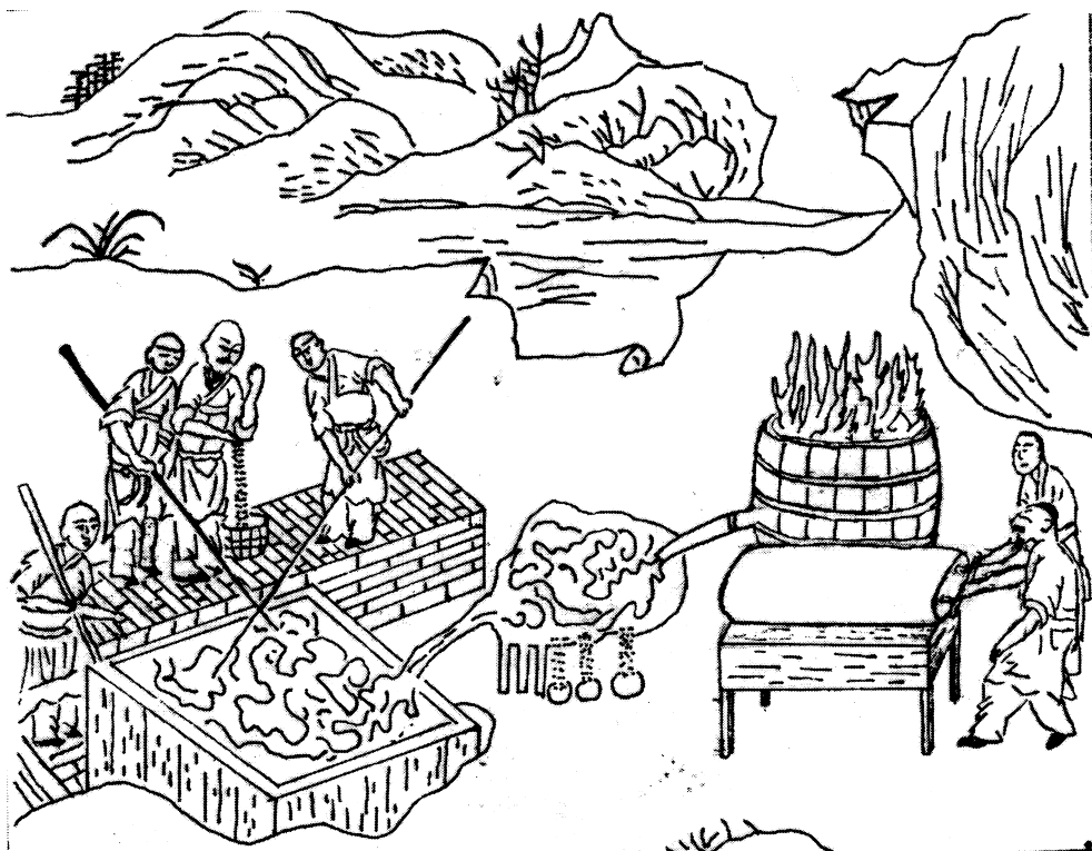
圖二：石倉煉鐵爐之復原，據圖一改繪
