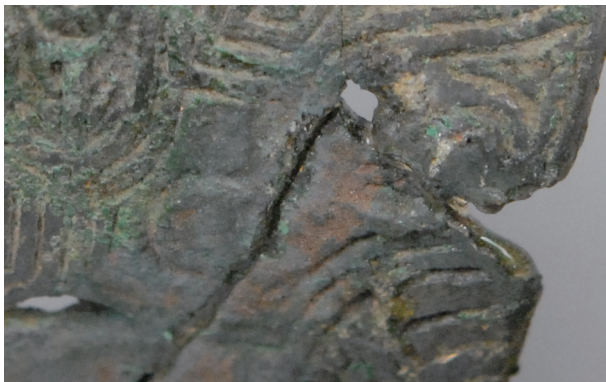
圖二四：花瓣殘片接合處溢膠，黏著劑（蟲膠）已劣化與黃化
