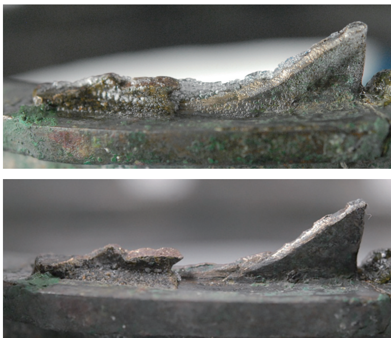
圖二六：連接花瓣 D 的華蓋斷面殘膠清潔前（上）與清潔後（下）對照圖
